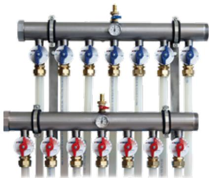
Colector en acero inox de Ø 2" para la distribución de los tubos de Ø 25 mm en aplicaciones industriales; compuestos de válvulas de corte y de regulación, grifo de vaciado y llenado de la instalación, termómetros 0-60 °C en ida y retorno, racores para tubo de Ø 25 mm.
