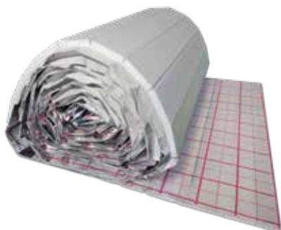
Panel liso de poliestireno expandido sinterizado fabricado según UNE EN 13163 y revestido en la parte superior con una lámina de PET que lleva impreso un patrón de cuadrícula para la instalación del tubo con paso 5 cm. Solapamiento lateral y suministro en rollos para agilizar la instalación del sistema.
