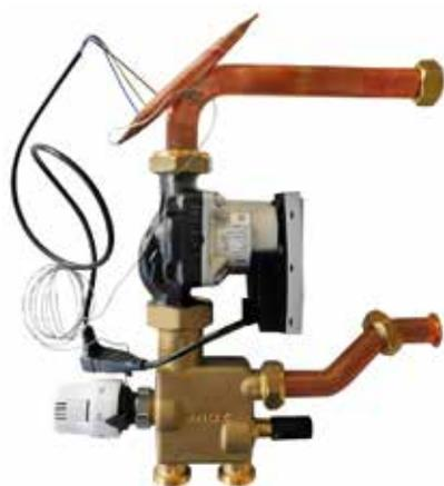
Módulo de mezcla adecuado para la regulación y el control de pequeños sistemas de calefacción por suelo radiante. Incluye una válvula mezcladora con un rango de temperatura de hasta 50 °C (sólo para calefacción), bomba de circulación electrónica, válvula unidireccional, bypass de equilibrio, tuberías para la conexión con colectores Easy Steel, soportes para fijar el Grupo de Mezcla PF en el armario. Las salidas de alta temperatura NO están disponibles.
