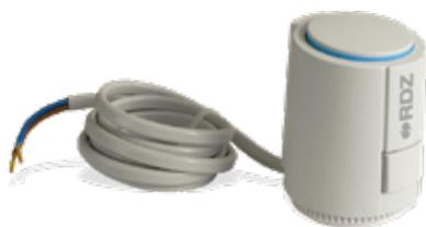
Cabezal electro-térmico para controlar cada circuito mediante termostato ambiente. Puede ser instalado de forma invertida. Visualización de su funcionamiento (abierto/cerrado), instalación sencilla mediante fijación rápida con adaptador (incluido). Funcionamiento 230V con o sin micro de final de carrera y 24V con micro de final de carrera. Grado de protección IP 54 (para todas posiciones). Puede ser utilizado con los colectores CONTROL, b!klimax, TOP COMPOSIT y Alta Temperatura Kit.
