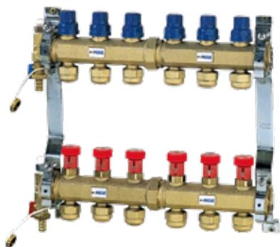
Colectores serie CONTROL Ø 1 ¼" en latón para la distribución de las tuberías a los ambientes, compuestos por válvulas de corte, (adaptables para cabezales electrotérmicos), detentores micrométricos con individuación de las salas, grupo de purgado y vaciado de la instalación con válvula de esfera tapón y junta de goma, soportes con gomas antivibración para colocación en armario o fijación a pared y conexiones para tubos de polietileno reticulado diám. 20 mm.
