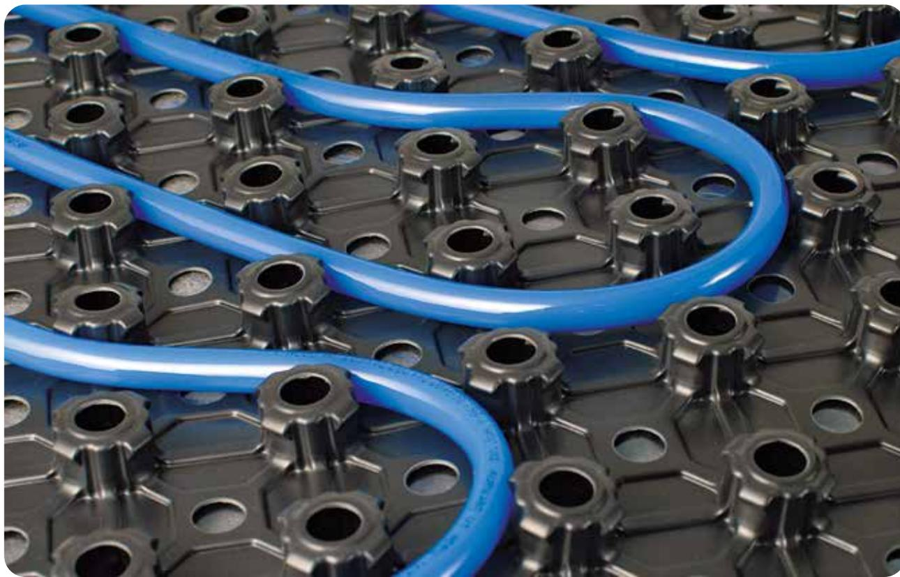
**Quota Zero AD** es un sistema de calefacción y refrescamiento de suelo de baja inercia térmica y muy bajo espesor, con tuberías PB de Ø 12 mm ancladas a una placa termoconformada y empotradas en el hormigón autonivelante.
