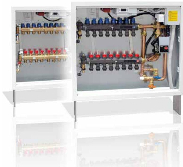
El Kit es un dispositivo que incluye en un solo producto, adecuado para su instalación en el ambiente, la parte de distribución radiante (sistema de suelo radiante), la termorregulación y las unidades de alta temperatura para conectar hasta 3 radiadores. El modelo **Easy Clima**, en particular, es adecuado para la gestión del funcionamiento de la calefacción y el refrescamiento.
