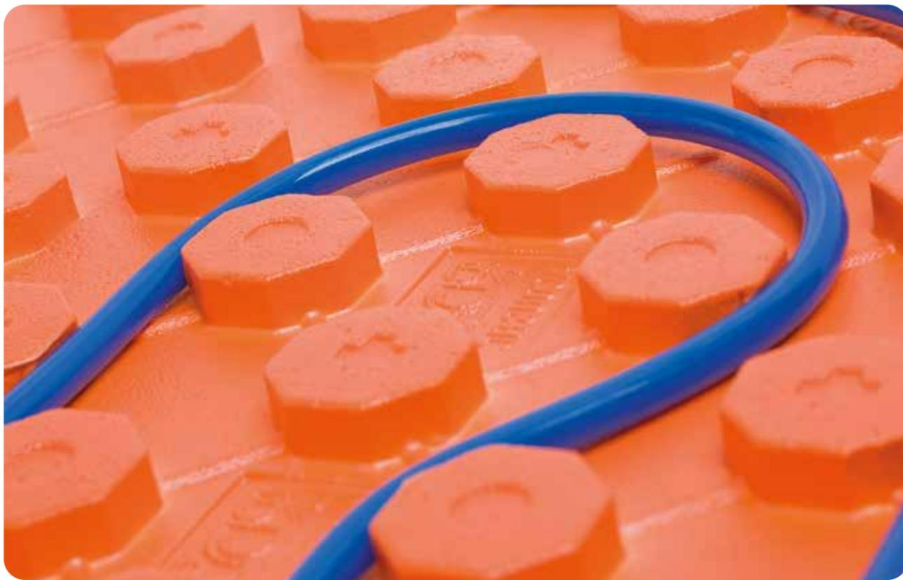
**Acoustic Plus** es un sistema de calefacción y refrescamiento con paneles de suelo radiante, de tipo tradicional, caracterizado por tuberías ancladas a una base aislada y empotradas en el hormigón.
